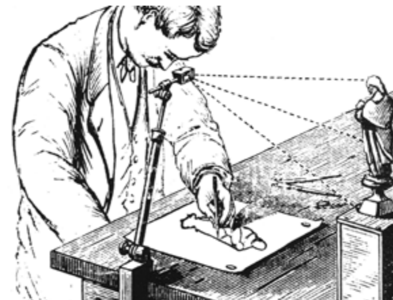
Illustration du principe de la chambre claire
